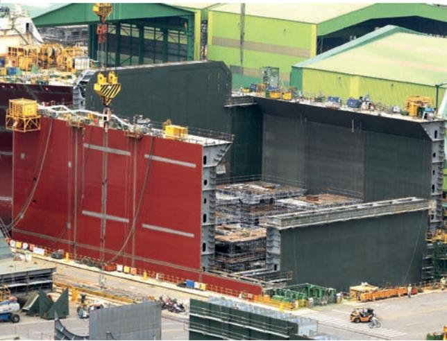
Pour ce faire, deux technologies sont disponibles : les méthaniers Moss-Rosenberg, dont les réservoirs sphériques sont ancrés à la coque du navire par une jupe en acier ; et les méthaniers à membrane, dont les cuves sont intégrées à la double coque du navire. Seule une dizaine de chantiers navals sont capables de construire de tels bâtiments, dont le prix unitaire d'environ 200 millions de dollars en fait les navires de charge les plus onéreux qui soient.
